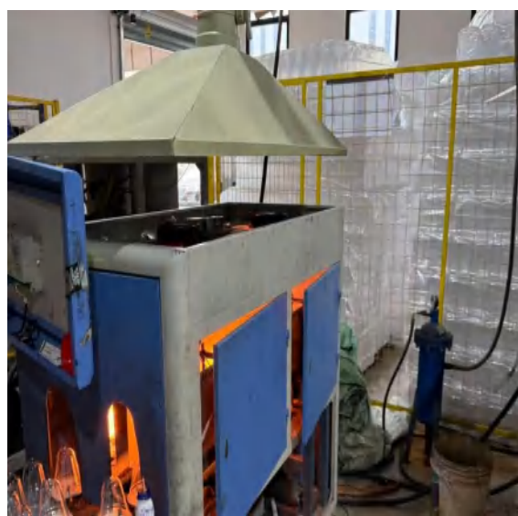
吹瓶废气收集设施
