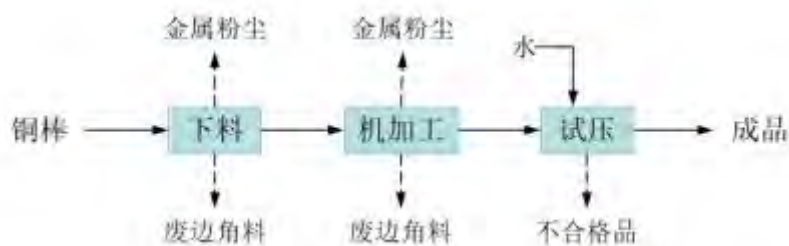
图 2-5 铜球阀配件生产工艺流程图及产污环节示意图
