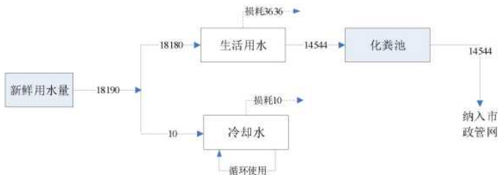
图 2-3 本项目水平衡图（单位：t/a）
