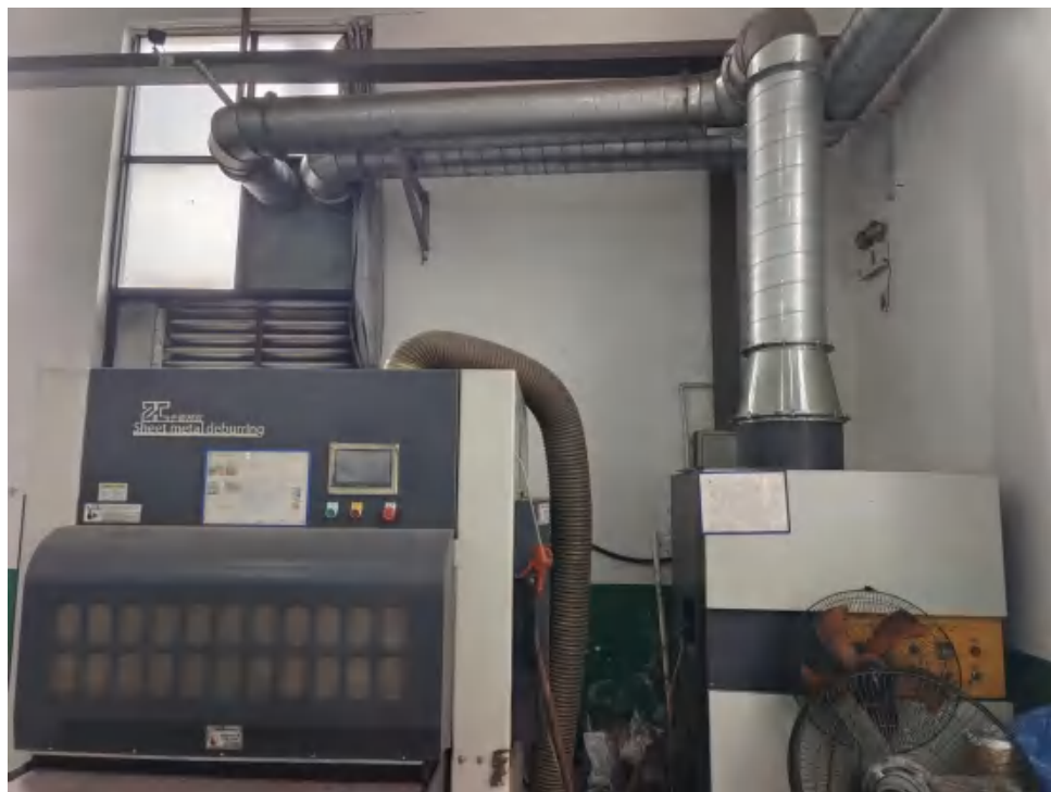
去毛刺粉尘处理设施（工业脉冲除尘装置）
