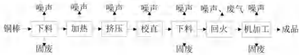
图 2.6-2 压缩机配重块生产工艺流程及产污环节示意图
