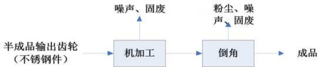
图 2-5 项目输出齿轮生产工艺流程及产污环节示意图
