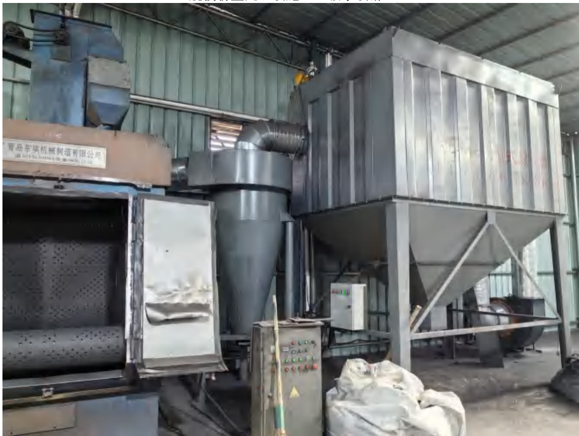
抛砂粉尘处理设施（旋风除尘+布袋除尘）
